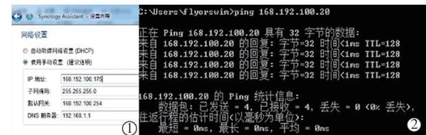
①设置 DS918+的 ip 地址掩码及 dns;②测试网络可 ping 通
