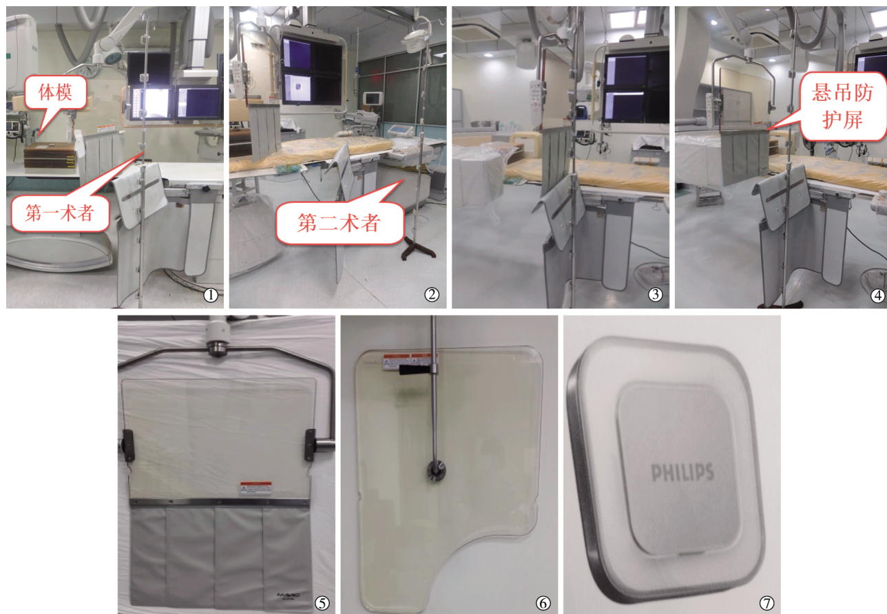
①正位投照防护屏近术者及第一术者位;②正位投照防护屏远离术者及第二术者位;③左侧位投照防护屏在术者左侧;④左侧位投照防护屏贴近球管;⑤混搭式防护屏(宽 50 cm,高 70 cm),⑥玻璃式防护屏(宽 60 cm,左侧高 50 cm,右侧高 75 cm,下缘宽 25 cm),⑦DoseAware 个人计量仪
