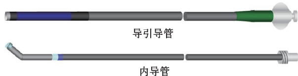
图 1 Chaperon 导引导管系统结构
